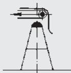
La macchina dispone tutte le pelli diritte e provvede a depositarle automaticamente in modo da far coincidere la mezzeria della pelle con l'asse centrale del cavalletto.
