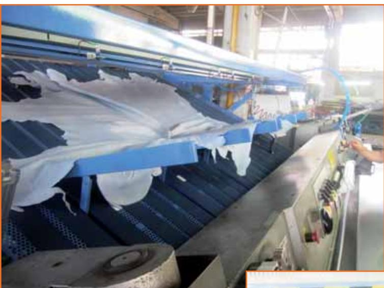
**NUOVO SISTEMA PER IL CONTROLLO DELLO SPESSEZZO:** permette di alzare la pelle proveniente direttamente dalla spaccatrice per controllarne lo spessore (sistema comandato dall'operatore); consente un notevole risparmio di tempo rispetto agli Stackers tradizionali perché lo spessore della pelle viene controllato dall'operatore **subito dopo l'uscita della pelle dalla spaccatrice**.
